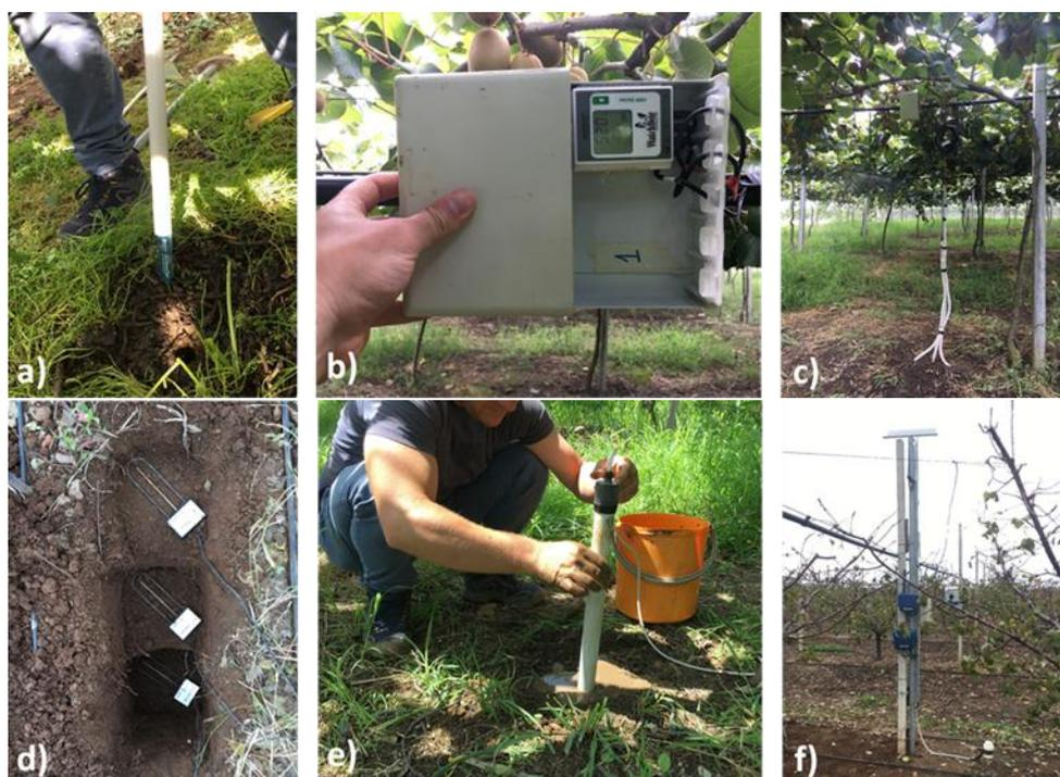
Figura 10. a-b-c): illustrazione di alcune fasi installazione di sonde per il monitoraggio dell'umidità del suolo, sonde SM100 waterscout spectrum (tecnologia FDR). d) sensori FDR Netafim installati a 20-30-60 cm di profondità. f) sistema Irrisense con sonda di profilo con sensori FDR integrati e con centralina per acquisizione dati e controllo da remoto (da Dichio et al., 2020).
